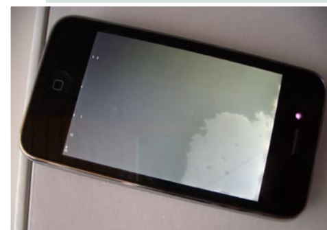
Het beschadigde scherm na de regentest.
