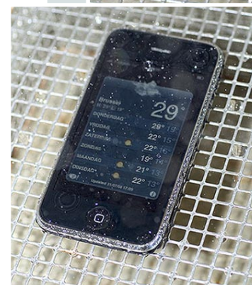
We onderwierpen de iPhone aan een regen-test in verticale én horizontale positie.
